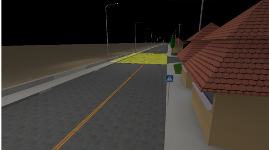
Figura 8 - Delimitação da superfície de cálculo no DIALux entre os dois postes (espaço amostral).
