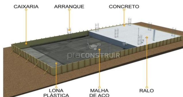
Figura 7- Construção de Laje Radier
