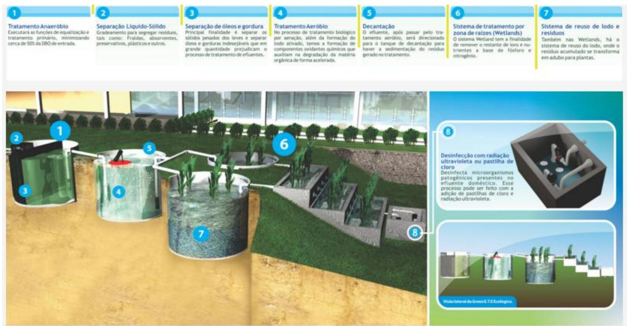
**Figura 62: Estação de tratamento ecológica Ecobox-Bio.**
