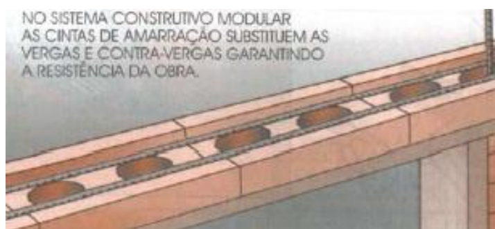
Figura 21 – Execução das vergas de amarração Fonte: SAHARA – 2001
