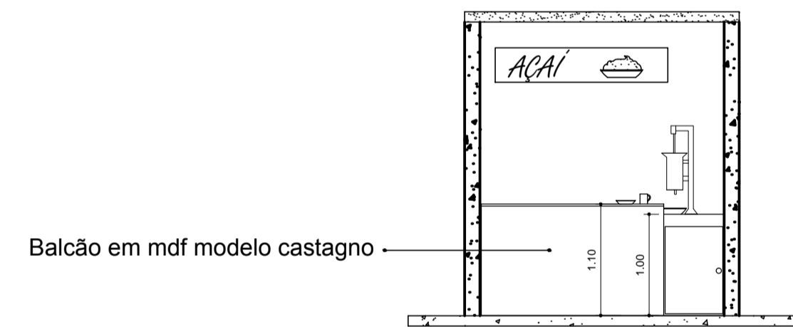
DETALHAMENTO PONTO DE AÇAÍ esc.: 1:50
