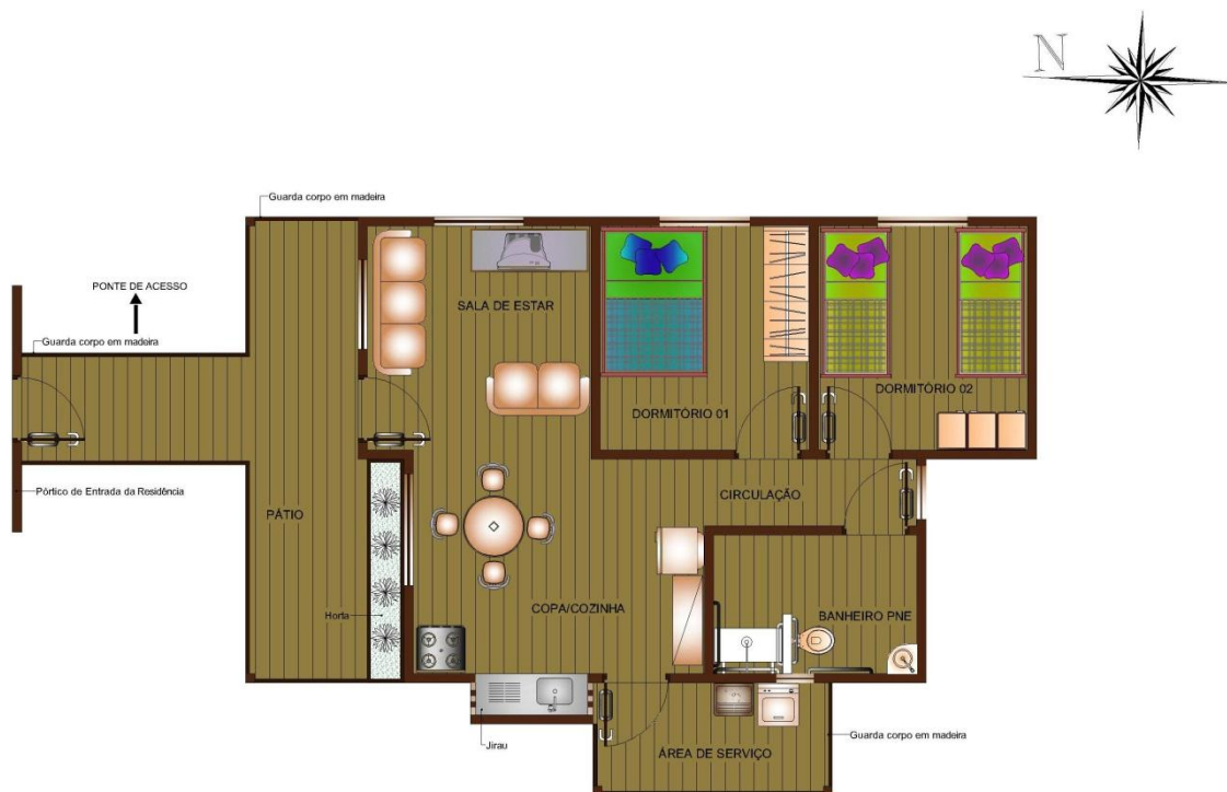
Figura 65: Planta baixa humanizada da proposta de habitação com adaptação para portadores de necessidades especiais.
