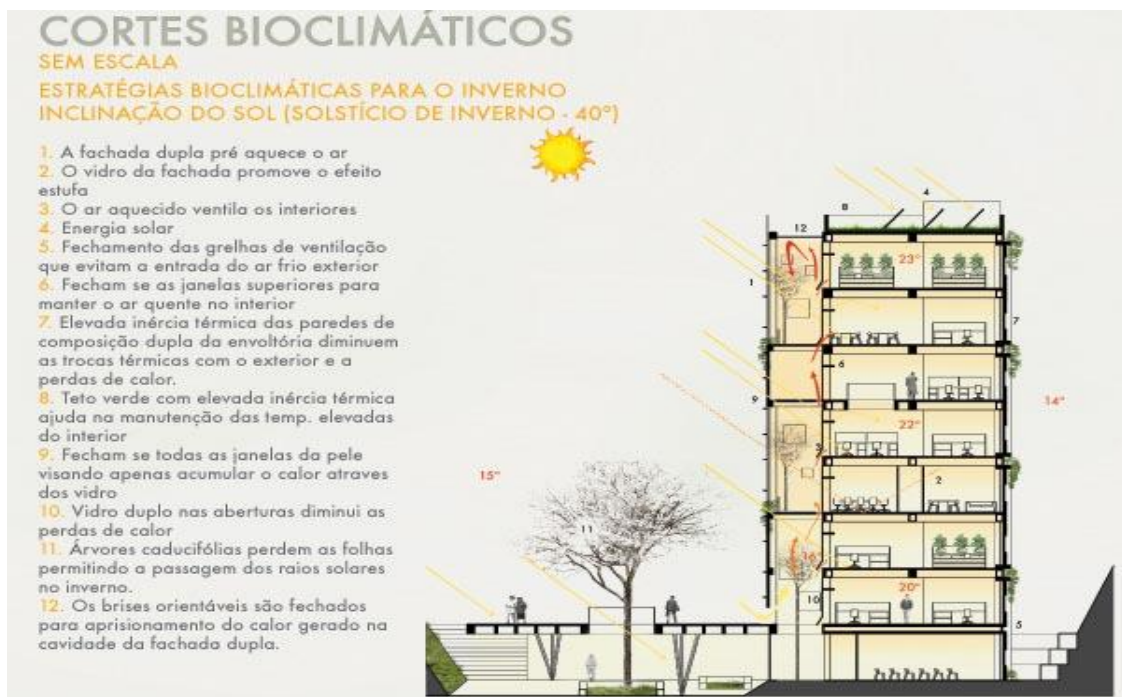
FIGURA 33 – Corte esquemático. Estratégias bioclimáticas para o inverno
