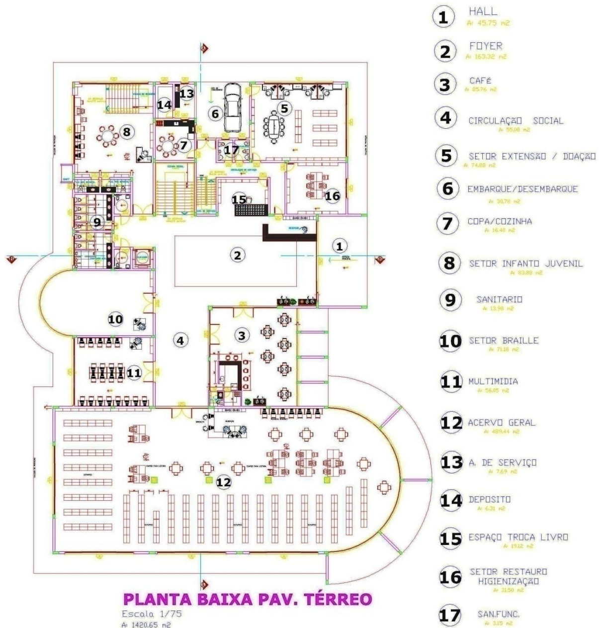
FIGURA 42 – Planta baixa pavimento térreo.
