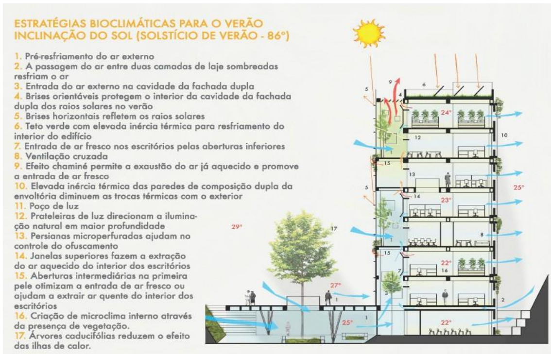
FIGURA 32 – Corte esquemático. Estratégias bioclimáticas para o verão
