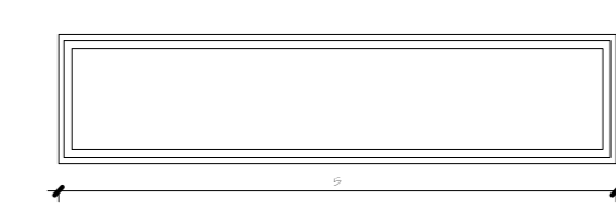
PSP QUANTIDADE: 1 DIMENSÕES (EM OSSO): 5x1.15 MATERIAL: MADEIRA TIPO: 1 CAIXILHO COM VIDRO DE ABRIR LOCAL
