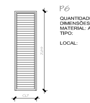
P6 QUANTIDADE: 36 DIMENSÕES (EM OSSO): 0.7x2.55 MATERIAL: ALUMINIO TIPO: 1 FOLHA LOCAL
