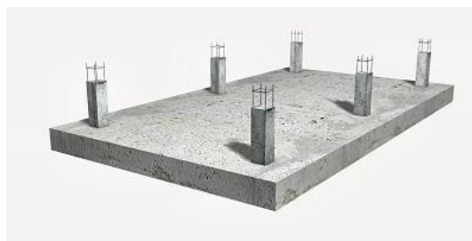
Figura 104 – Fundação em radier
