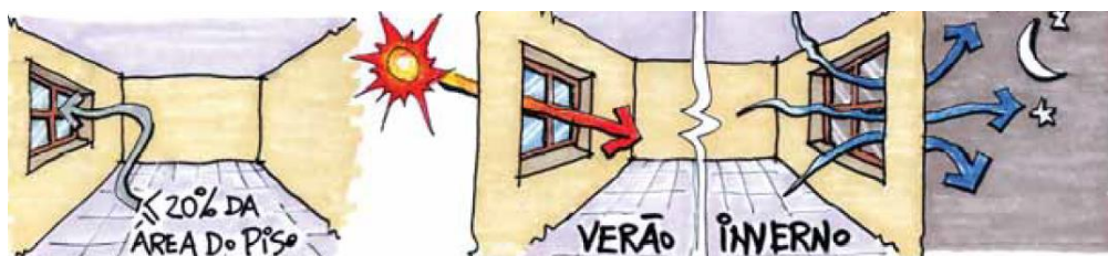
Figura 17 – Área de janela em função da área de piso
