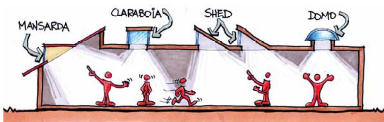
Figura 19 – Tipos de iluminação zenital.
