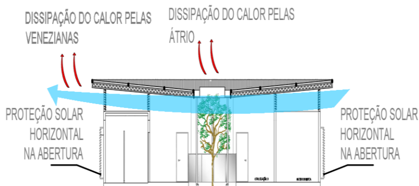
Figura 90 – Ventilação no ático do setor consultórios
