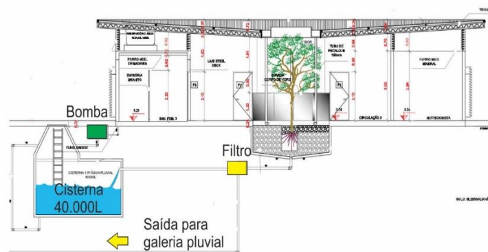
Figura 103 – Esquema 2 de reaproveitamento das águas pluviais
