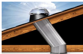
Figura 22 – Duto de iluminação natural
