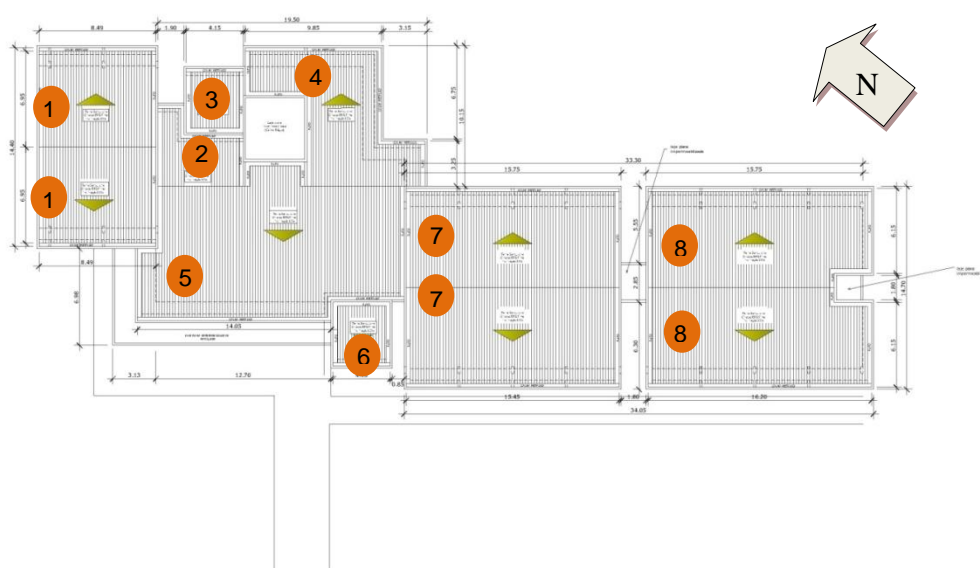
Figura 31: Planta de cobertura.
