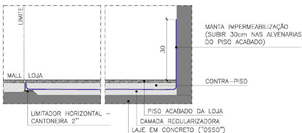
Figura 3-Detalhe Manta para Impermeabilização do Piso
