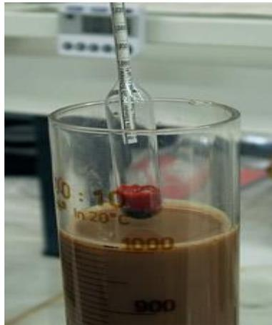
**Figura 8-** Coleta da Sedimentação com a Pipeta
