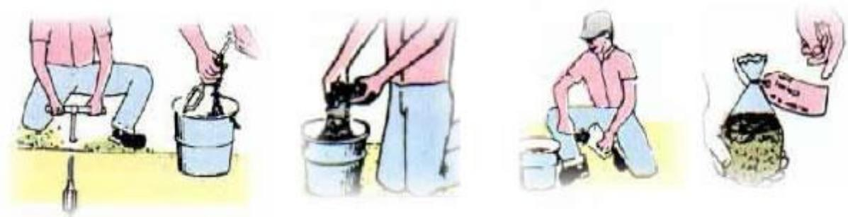
**Figura 2-** Procedimentos Padrão para Coleta de Amostra de Solos.
