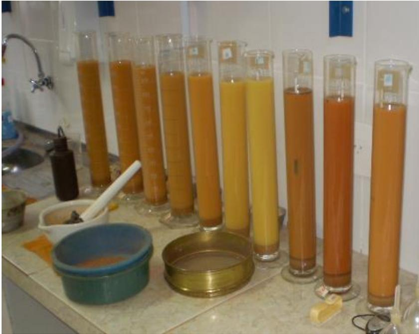
**Figura 7-** Determinação do teor de Argila.
