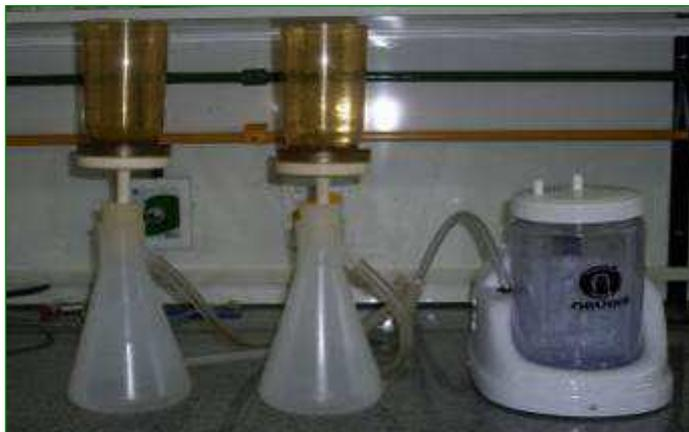
Figura 4: Filtração das amostras para quantificação de clorofila-a
