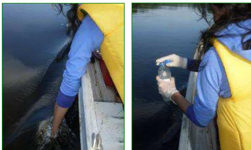
Figura 3: Coleta superficial de amostras para determinação da clorofila-*a*
