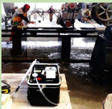
Figura 2 – Operação do RAD7 nas marmorarias.
