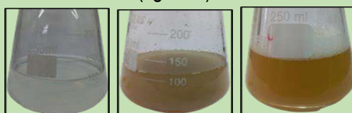
Figura 3 - Solução das NPFe. 1) Controle Tampão fosfato + \text{Fe}(\text{NO}_3)_3 \cdot \text{H}_2\text{O} . 2) Solução NPFe agitação convencional. 3) Solução NPFe da autoclave.
