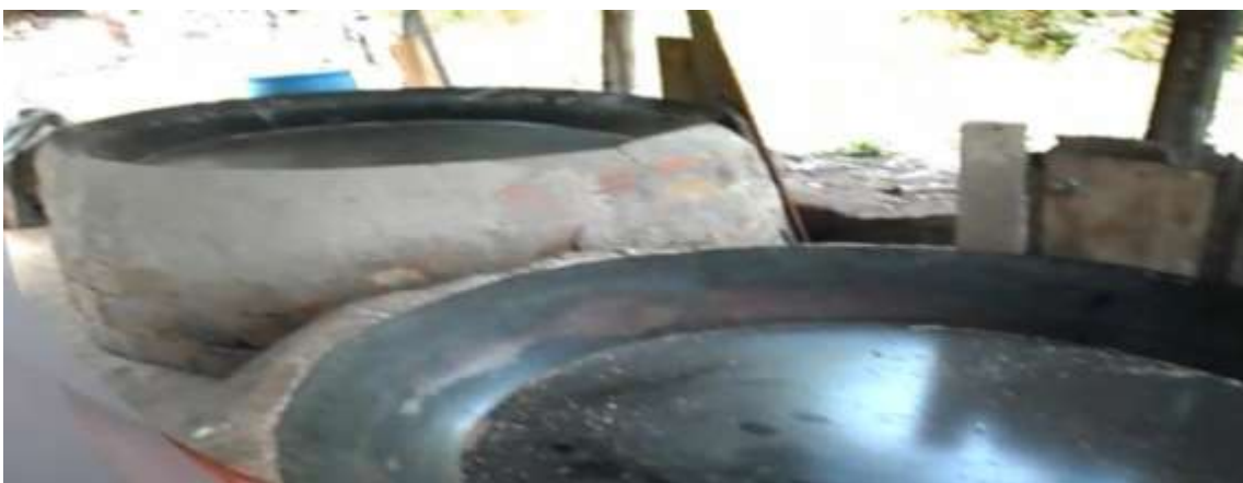
Figura 02- Torradeira usada para torrar a popa da mandioca.
