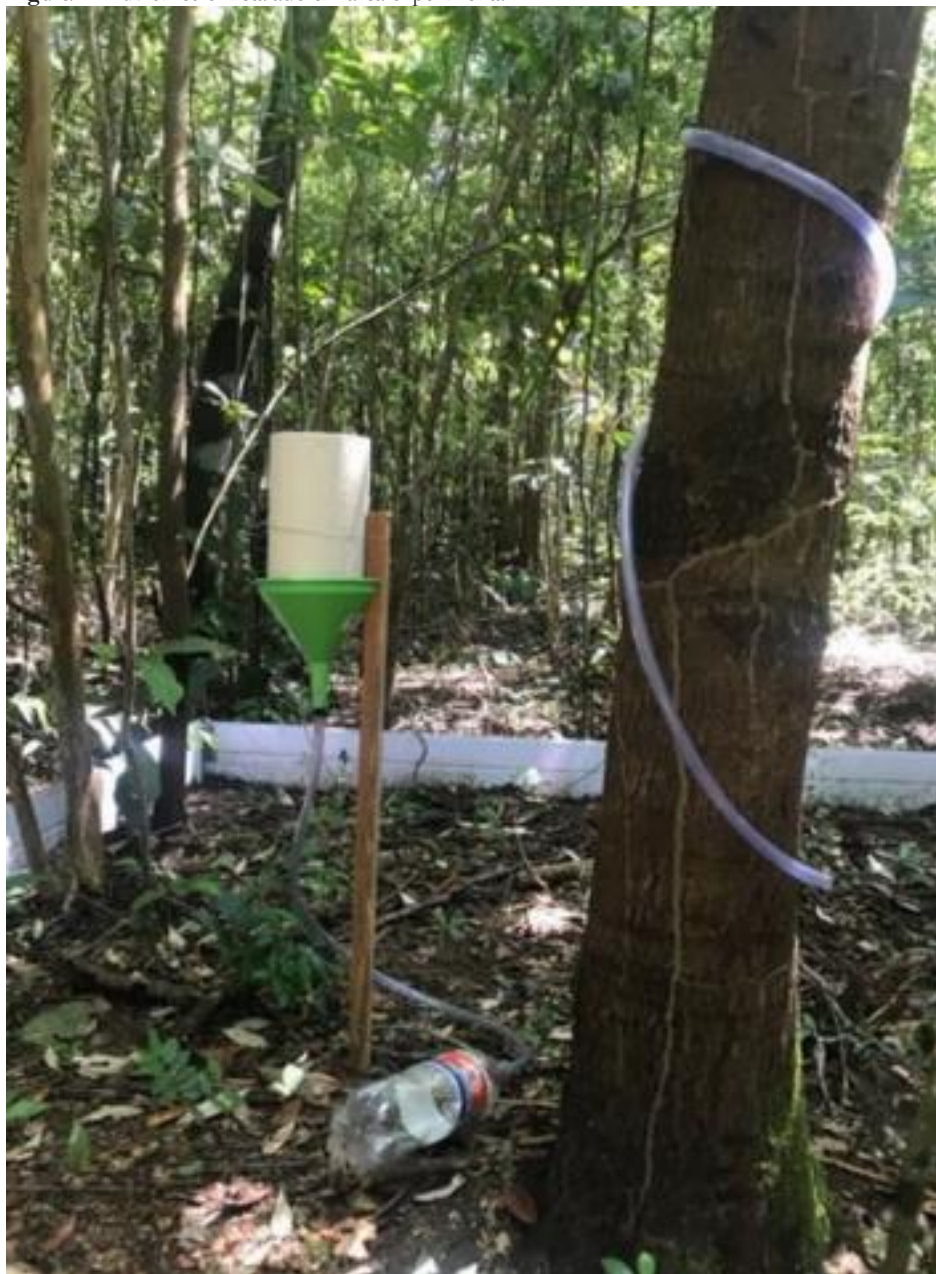
Figura 1- Pluviômetro instalado em área experimental
