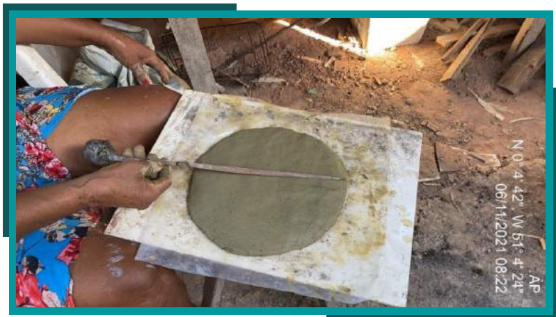
Fotografia 49 - Verificação das medidas da tampa.
