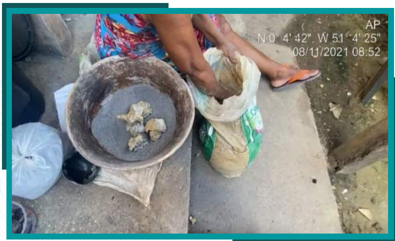
Fotografia 33 - Mistura da argila limpa com o caripé processado.
