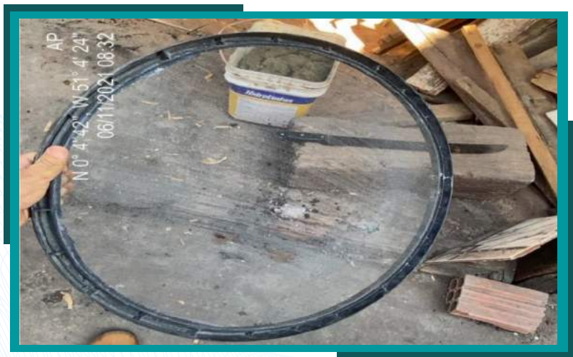
Fotografia 30 - Peneira com abertura de malha de 1,18 mm (n° 16 – ASTM).
