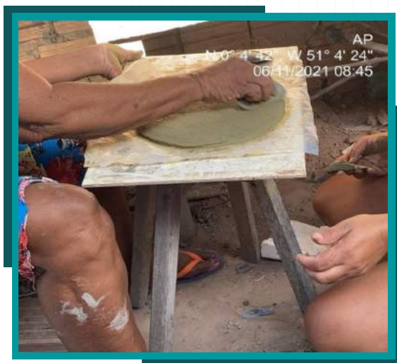
Fotografia 50 - Execução do alisamento da tampa com a cuiabeba.
