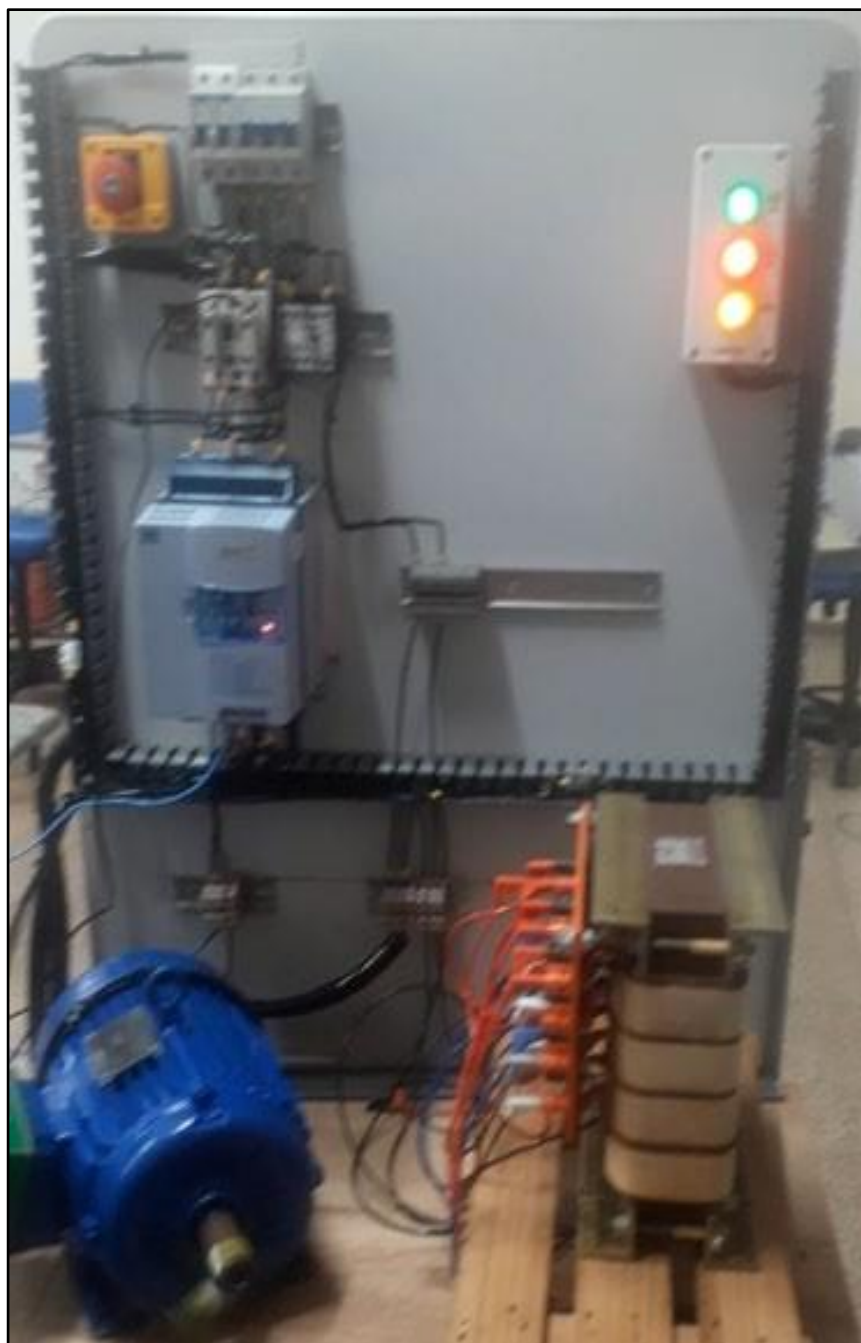
Figura 10 – Bancada didática em pleno funcionamento, Motor de indução trifásico (b).
