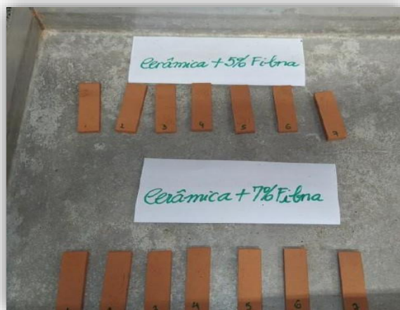
Figura 12 – Corpos de prova com 5% e 7% de fibra de coco
