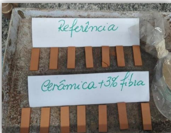
Figura 11– Corpos de prova referência e 3% de fibra de coco
