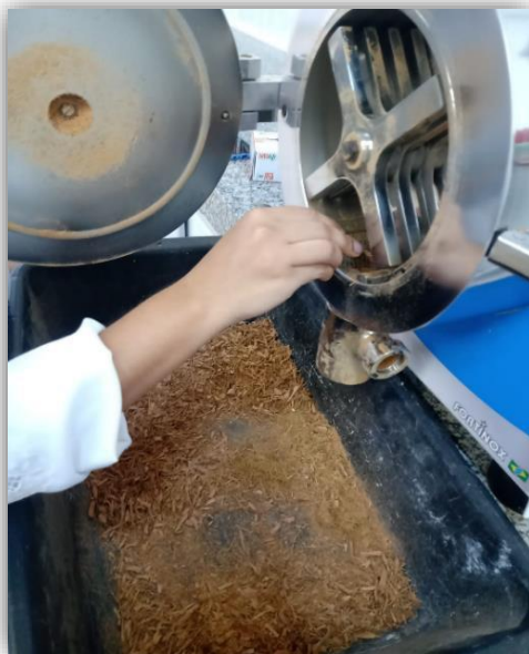
Figura 02 – Fibra triturada no Moinho de martelos
