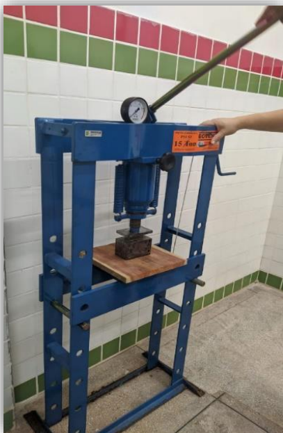
Figura 09– Prensagem dos protótipos na prensa hidráulica
