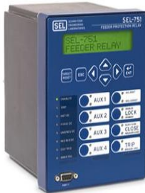
Figura 8 - Relé de proteção SEL- 751 usado em alimentadores.
