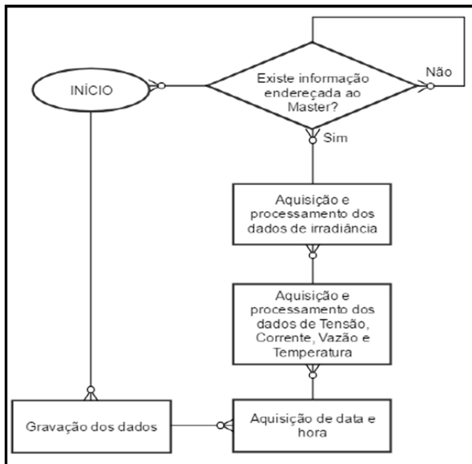
Figura 10: Fluxograma da lógica de controle do microcontrolador Mestre.
