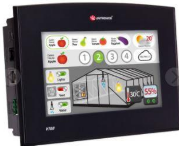
Figura 14 – CLP V700 com IHM incorporada.
