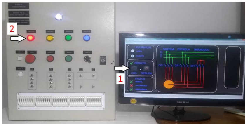
FIGURA B-20: ACIONAMENTO MODO MANUAL REMOTO
