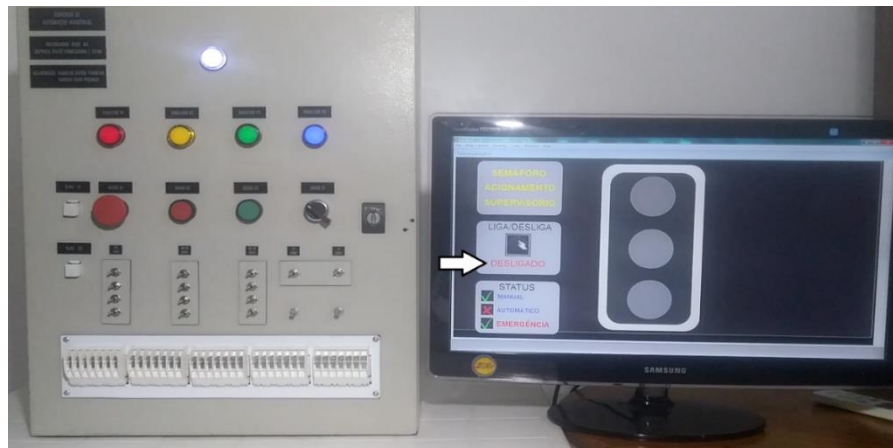
FIGURA B-7: STATUS DE SEMÁFORO DESLIGADO
