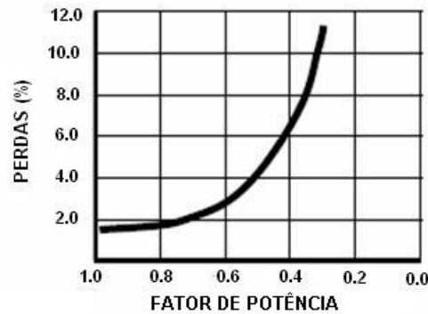
Figura 11 – Variação das perdas de energia em condutores em função do fp
