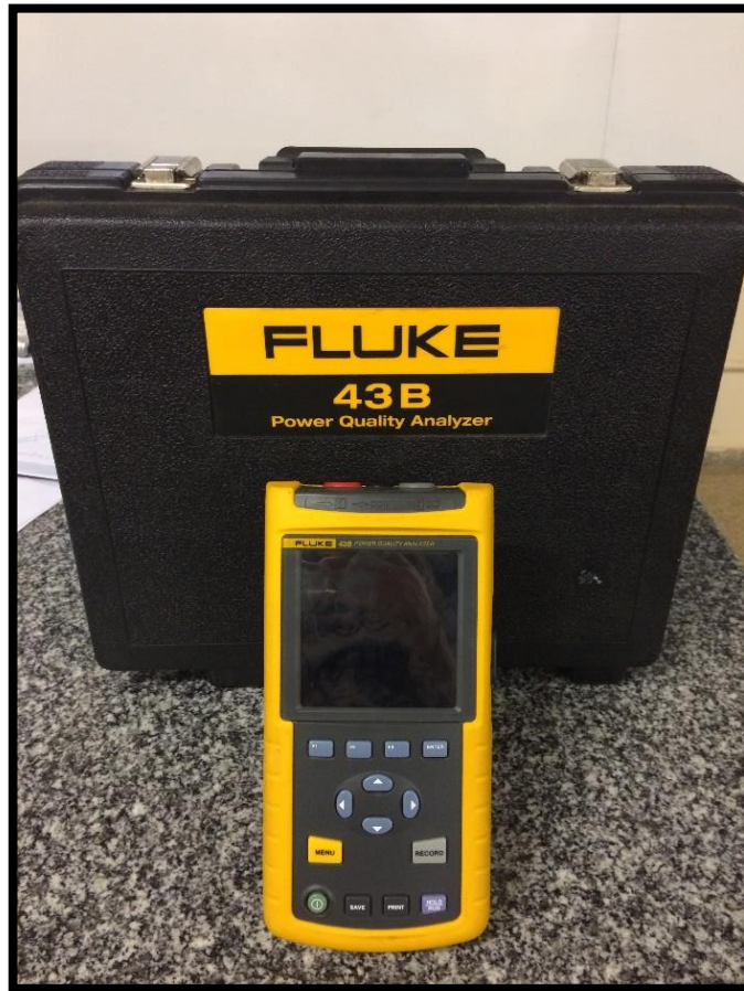
Figura 25 - Analisador de qualidade de energia Fluke 43B
