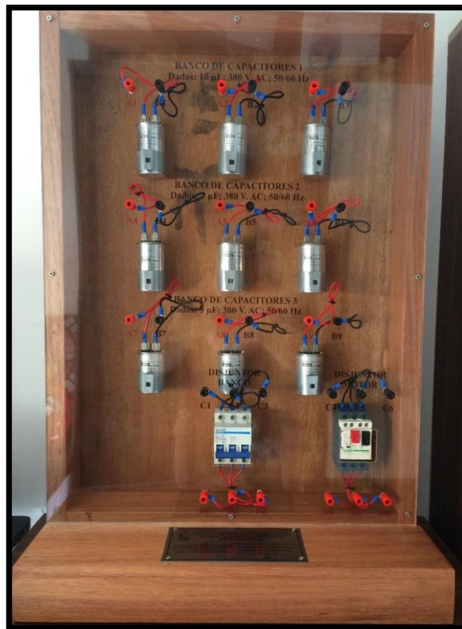
Figura 27 - Bancada didática com banco de capacitores para correção do fator de potência de um motor trifásico
