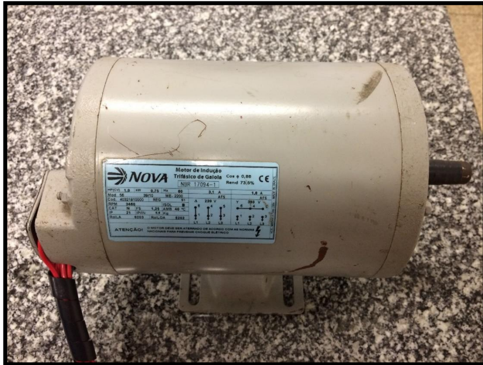
Figura 24 - Motor de indução trifásico de gaiola
