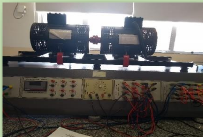
Foto 1 - Motor / Gerador Síncrono
