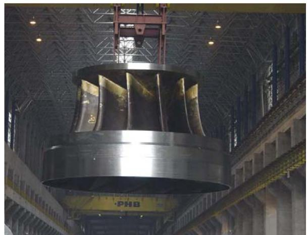
Figura 3.17 – Rotor da Turbina Francis.
