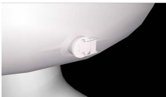
**Figura 5.15 – Porta eclusa da caixa espiral, passagem por onde se entra para realizar diversas manutenções.**
