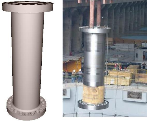
Figura 3.18 – Eixo da Turbina.
