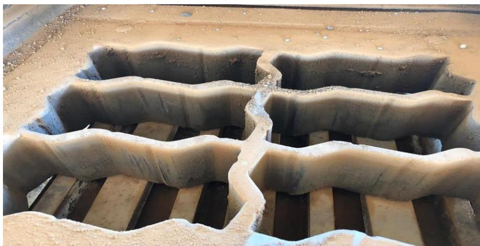
**Figura 33** – Molde ou fôrma para bloco 16 faces
