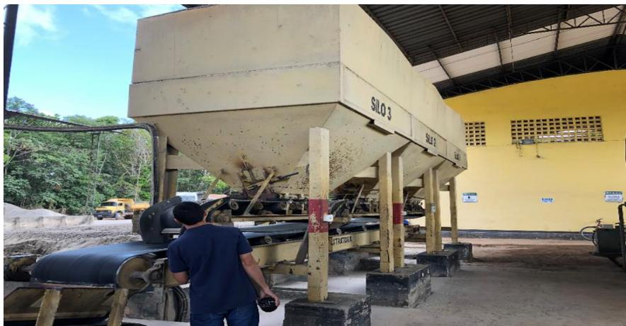
**Figura 13** - Silos de agregados frios
