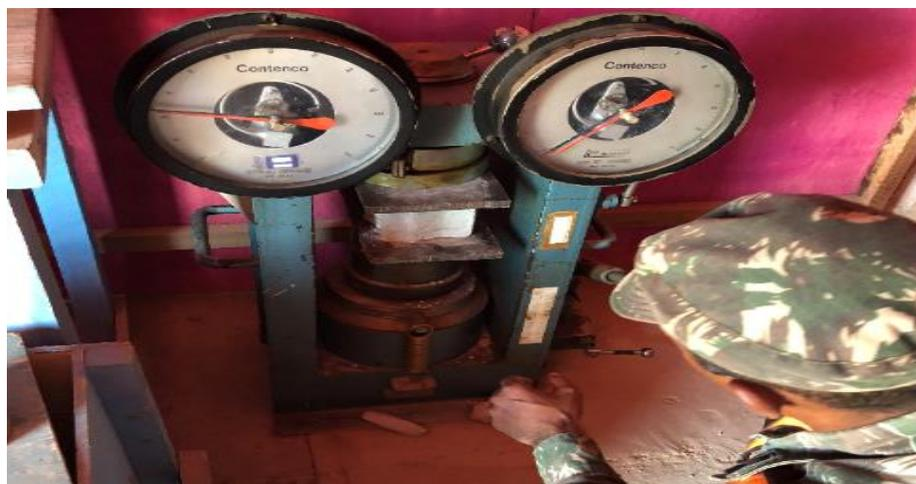
**Figura 39** – Ensaio de rompimento do bloquete
