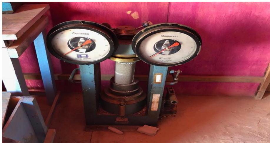
**Figura 40** – Ensaio de rompimento do corpo de prova
