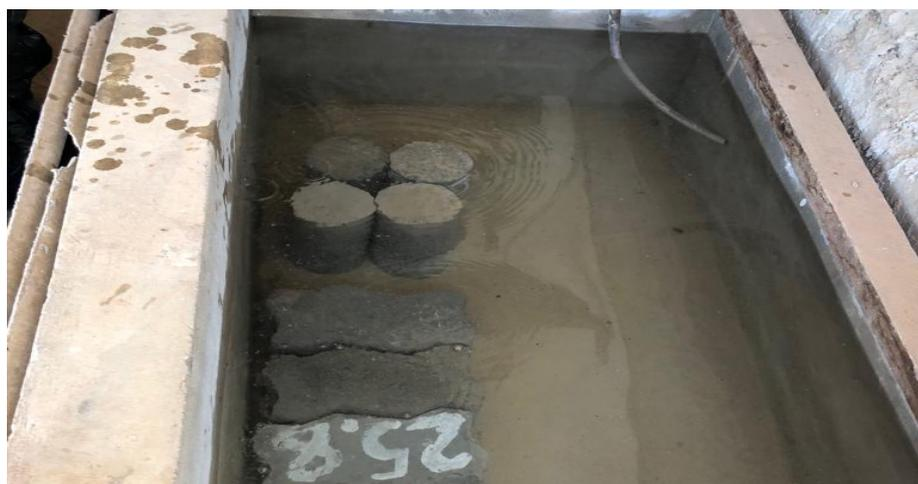
**Figura 41** – Tanque de imersão de corpo de prova
