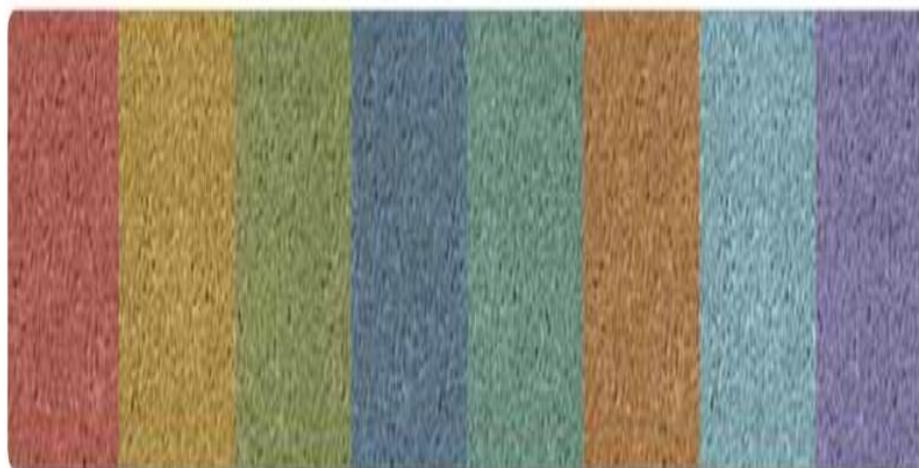
**Figura 27** - Cores possíveis de blocos de concreto através da pigmentação
