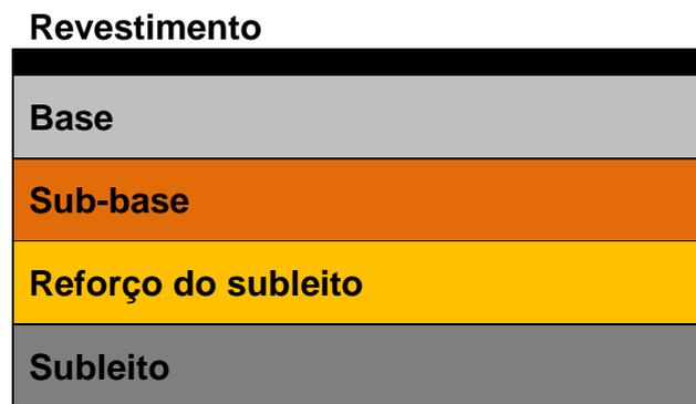
**Figura 7** - Representação das camadas de um pavimento
