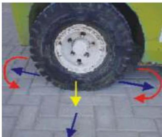
**Figura 26** - Forças vertical, horizontal e de giro
