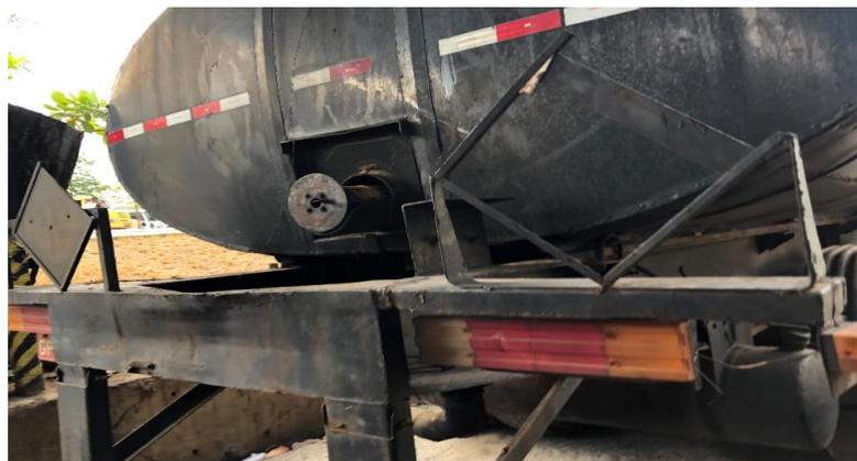
**Figura 11** - Caminhão cisterna para transporte de CAP
