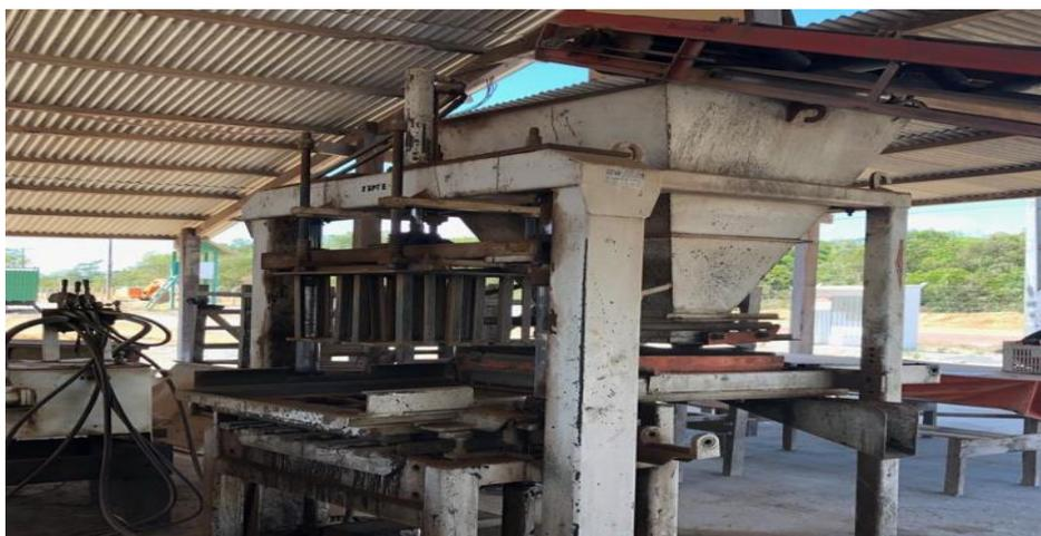
**Figura 32** - Vibroprensa
