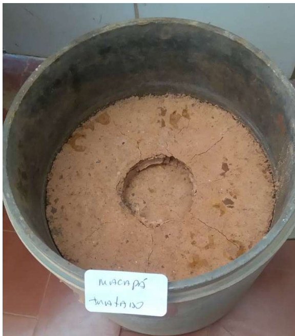
Figura 17 - Ensaio Proctor do Solo Tratado
