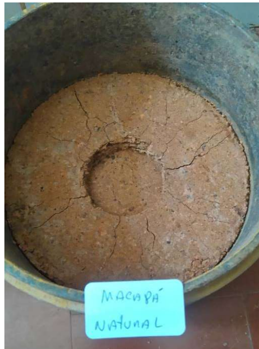
Figura 16 - Ensaio Proctor do Solo Natural, sem brita
