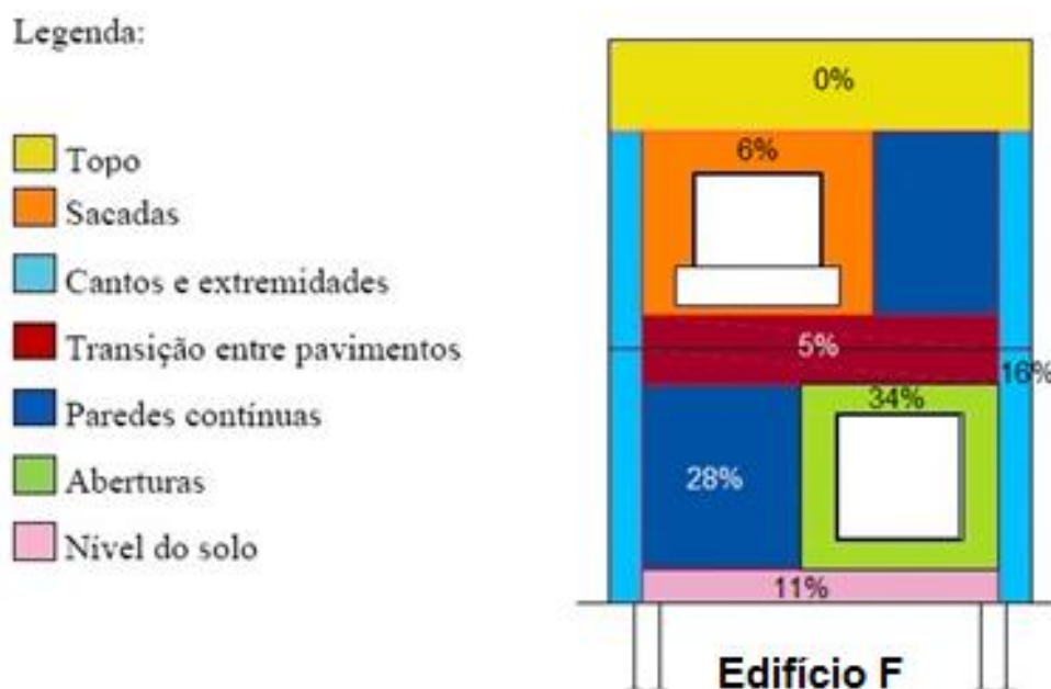
Figura 59 - Mapa de incidência de manifestações patológicas do edifício F
