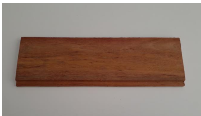
Figura 15 – Corpo de prova (450 mm x 140 mm x 16 mm)
