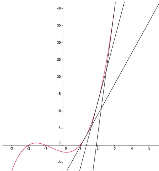
Figura 3.3: A representação do Método de Newton
