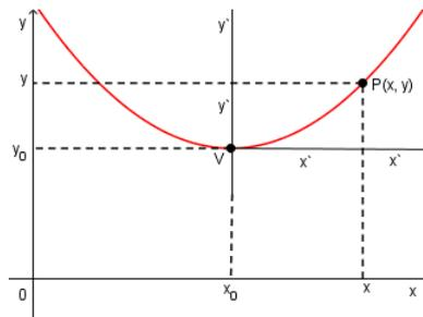
Figura 1.19: Representação da Parábola com Eixo de Simetria paralelo ao eixo y
