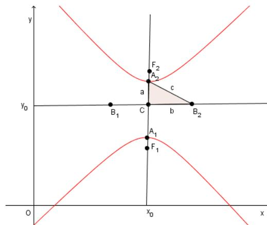
Figura 1.10: Hipérbole com o eixo real paralelos ao eixo  $y$
