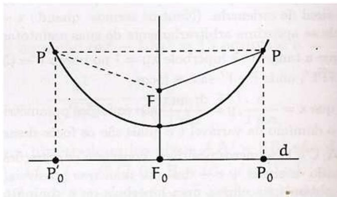
Figura 2.3:  $P$  pertence à parábola de foco  $F$  e diretriz  $d$  por que  $d(P, F) = d(P, P_0)$  com  $PP_0 \perp d$ . A perpendicular  $FF_0$ , baixada do foco sobre a diretriz, é um eixo de simetria.
