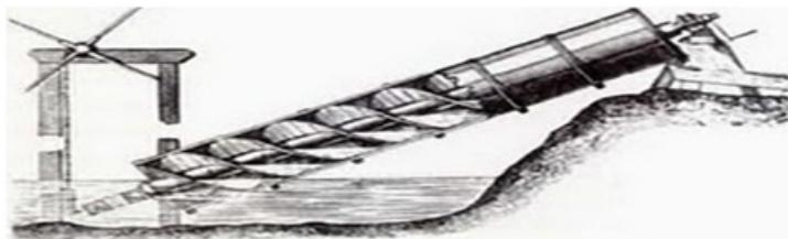
Figura 2.7: O parafuso de Arquimedes - Dispositivo capaz de transportar a água de um nível inferior para uma certa altura.
