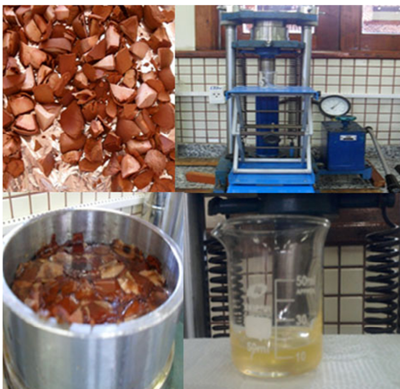
Figura 4- Etapas de extração do óleo de andiroba em prensa.
