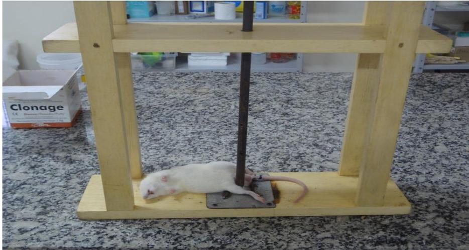
**Figura 05:** Animal posicionado no aparelho fraturador. O membro posterior do animal fica apoiado sobre dois suportes de 1cm de altura, separados por uma distância de 4cm. Foto do autor
