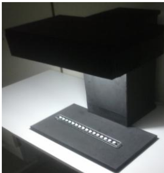
Figura 13. Iluminador Utilizado na Aplicação do Teste Psicofísico de Lanthony D15.
