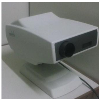
Figura04. Projetor GCP-7000 Utilizado Para a Aferição da AV
