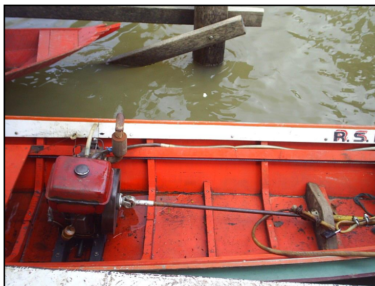
Figura 2: Embarcação ribeirinha com eixo do motor sem proteção Fonte: Castro, 2008.
