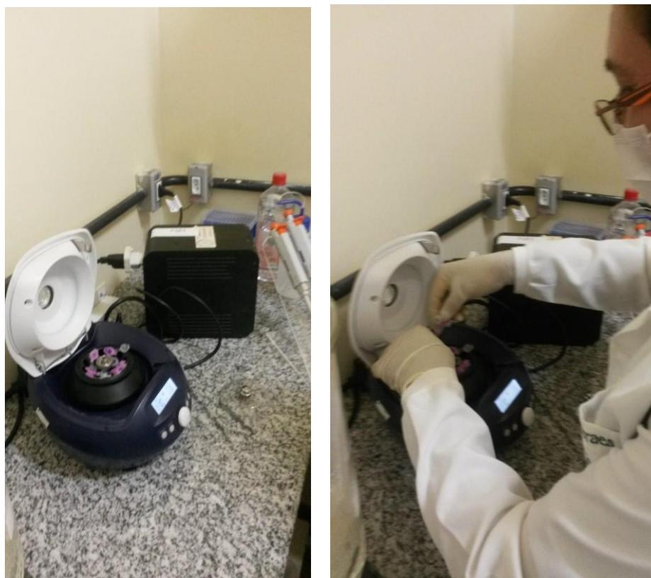
Figura 10. Centrifugação de amostras na etapa de extração do DNA/RNA.
