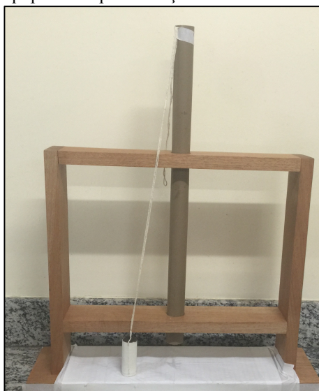
Figura 17. Equipamento para indução da lesão muscular traumática.
