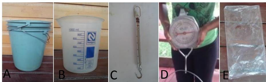
Figura 1 - Material utilizado: A) baldes de 20 L, B) béquer de 1000 ml, C) balança de 2,5 kg e precisão de 5 g, D) balança de 25 kg e precisão de 50 g, E) sacolas plásticas de 1 kg.
