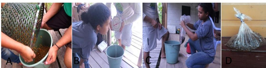
Figura 3 - Após despulpamento do fruto: A) nos baldes de 20 L são inseridos os caroços, B) os caroços são pesados com balança de 25 kg e precisão de 50 g, C) é retirado uma alíquota em um béquer de 1000 ml, e pesada em balança de 2,5 kg e precisão de 5 g, D) amostra de 1 kg que será levada para o laboratório.
