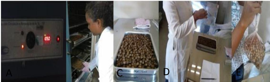
Figura 1 - Análise laboratorial: A) estufa de ventilação forçada, B) as amostras de 1 kg de caroço de açaí foram colocadas em uma estufa de ventilação forçada a  $65 \pm 2^{\circ}\text{C}$  e pesada a cada 24 horas, após estabilização, a temperatura foi elevada para  $105 \pm 2^{\circ}\text{C}$  durante mais 24 horas, C) amostra de açaí, D) pesagem da amostra de 1 kg, E) armazenamento após pesagem.
