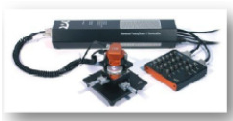
Figura 7 – AFM/STM modelo Easyscan2 do fabricante nanosurf usado neste trabalho. Fonte: Pinto et al. , 2013.
