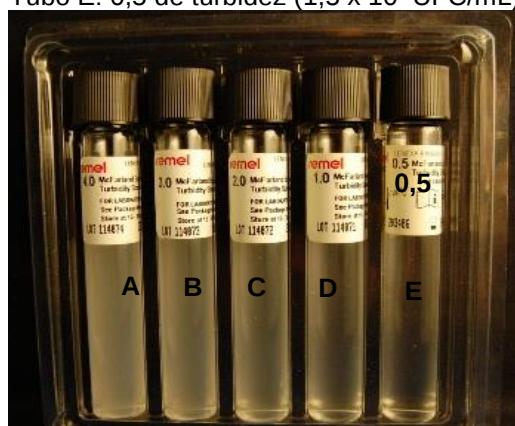
Figura 20. Escala MacFarland de turbidez Tubo E: 0,5 de turbidez ( 1,5 \times 10^8 UFC/mL).
