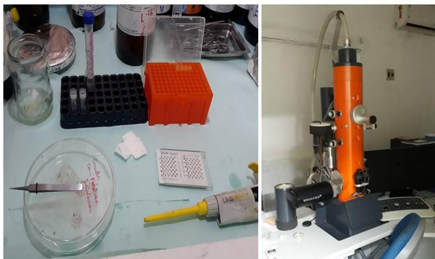
Figura 15 - Preparo das placas de cobre revestidas com formvar para visualização das amostras por microscopia eletrônica de transmissão a esquerda, e microscópio eletrônico de transmissão a direita.
