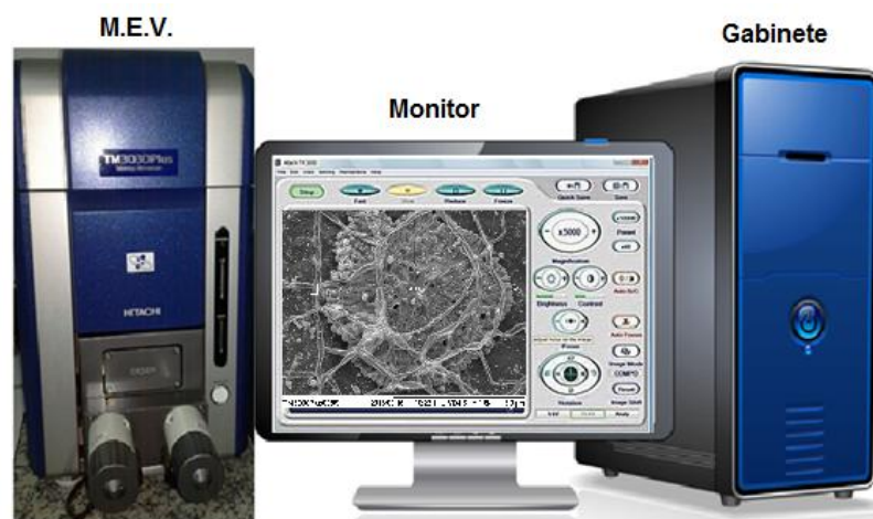
Figura 17 - Microscópio Eletrônico de Varredura (M.E.V.), modelo HITACHI TM3030Plus.
