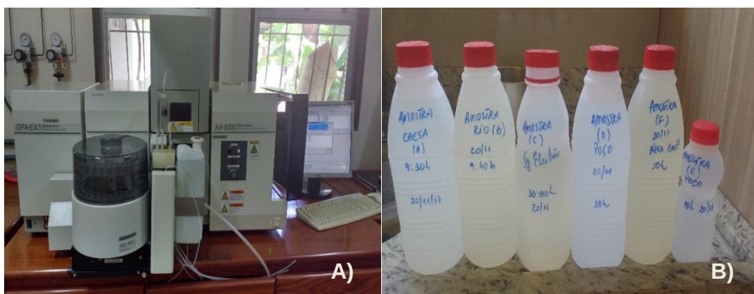
Figura 3 – Análise de metais na água. A) Espectrofotômetro de Absorção Atômica com Chama (F-AAS), modelo AA-6300 e B) As amostras de água coletados do bairro Elesbão, no município de Santana, Estado do Amapá.
