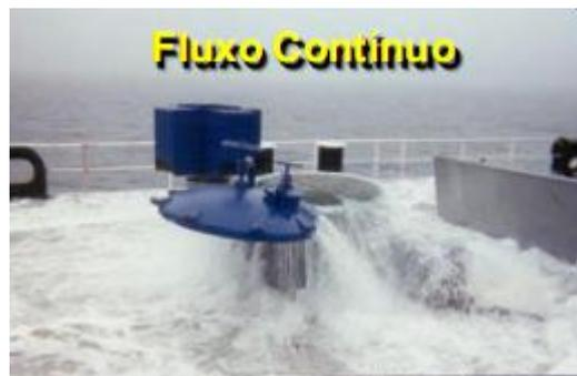
Figura 5: Troca da Água de Lastro pelo método do Fluxo Contínuo.
