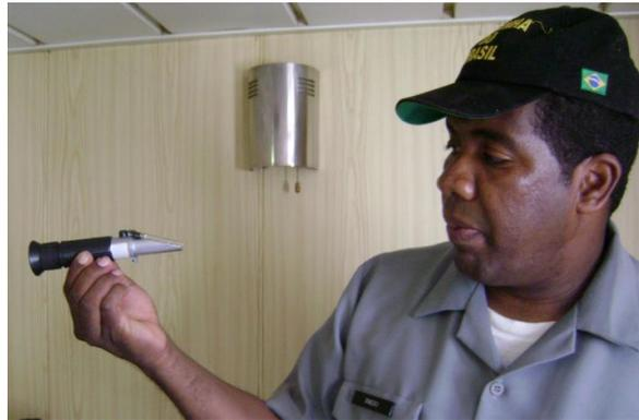
Figura 11: Refratômetro, instrumento utilizado para medir a salinidade da água de lastro.
