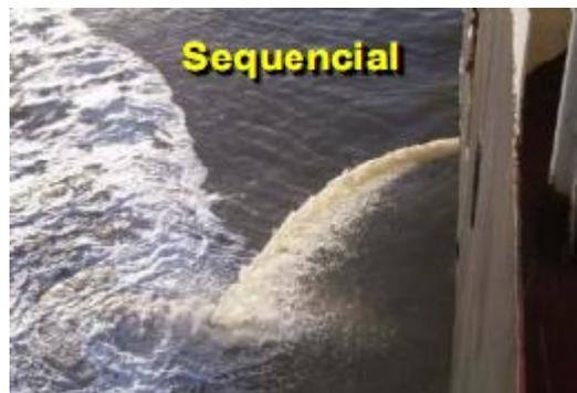
Figura 4: Troca da Água de Lastro pelo método Sequencial.
