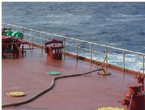
Figura 7: Troca da Água de Lastro pelo método da Diluição.
