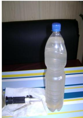
Figura 12: Refratômetro e garrafa contendo água de lastro colhida do tanque do navio.
