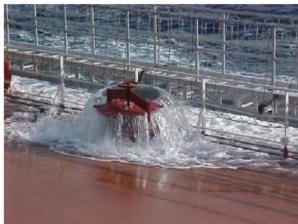
Figura 6: Troca da Água de Lastro pelo método de Transbordamento.
