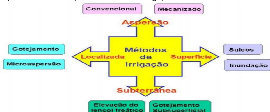
Esquema 3 -Classificação dos métodos de irrigação e suas subclasses.
