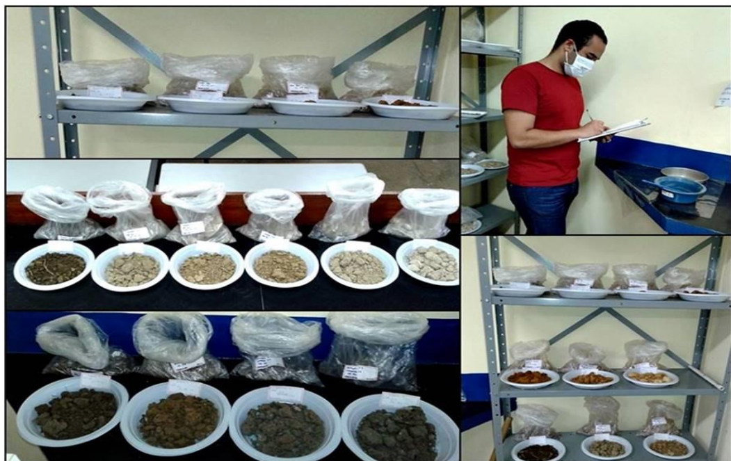
Figura 7 – Secagem, destorroamento e peneiramento das amostras – LAGESOL
